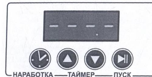
Рисунок А.7 - Вид панели при отображении непрерывного режима
