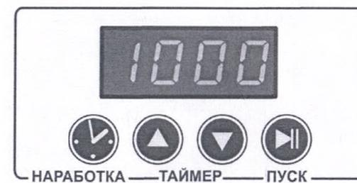
Рисунок А.3 - Вид панели при отображении времени наработки ламп
