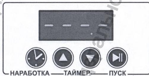
Рисунок А.7 - Вид панели при отображении непрерывного режима
