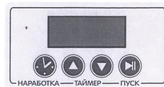
Рисунок А.2 - Внешний вид панели управления
