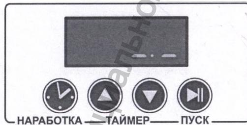
Рисунок А.5 - Вид панели при отображении окончания работы
